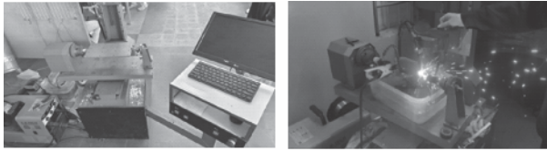
Hình 4. Mô hình máy hàn MIG WAAM 4 trục
