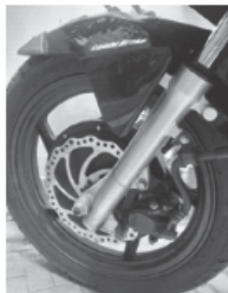
Hình 1. Hình ảnh động cơ điện gắn trên bánh trước xe Honda AirBlade
