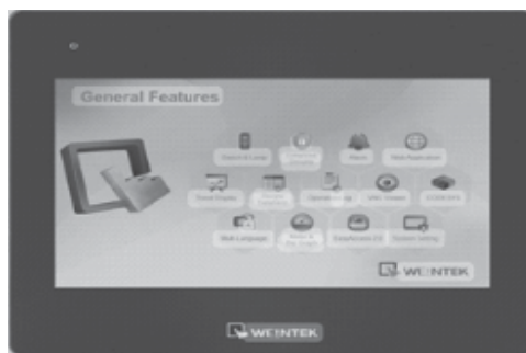
Hình 2.2. Màn hình điều khiển HMI Weinview
