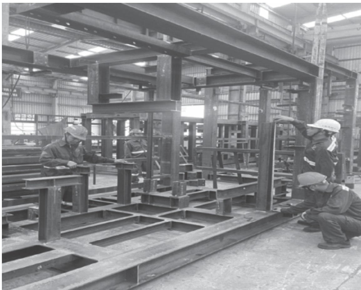
Cán bộ kỹ sư LILAMA 10 chế tạo 02 mô-đun thiết bị điện phân thuộc dự án nhà máy sản xuất hydrogen xanh tại West Coast (Mỹ).
