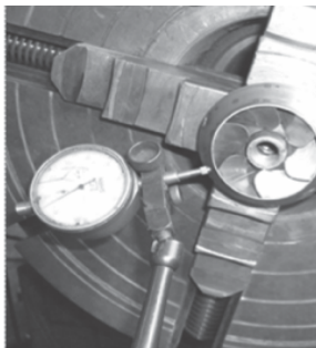
Kiểm tra độ tròn cánh bơm sau khi hàn
