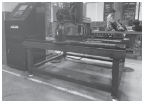
Hình 8. Sản phẩm hệ thống cắt plasma CNC
