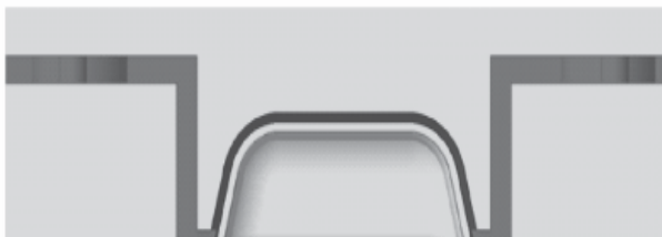
Hình 9: Kênh giải nhiệt hình 3D ở tấm khuôn âm
