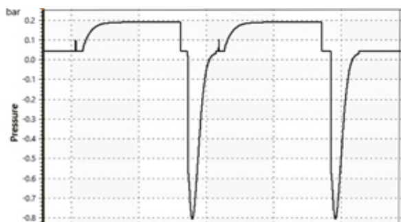
Hình 7a. Áp suất khoang không cần khi đập bình thường
