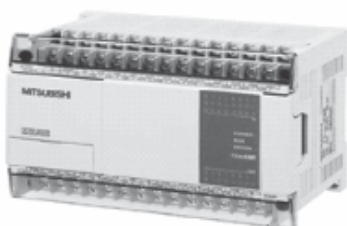
Hình 2.1. Bộ điều khiển PLC Mitsubishi FX1N-40MT-001
