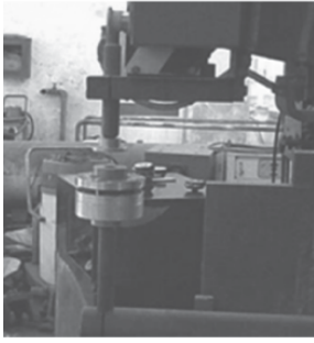
Lắp đồ gá và thổi hàn trên máy hàn điểm
