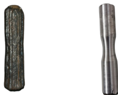
Hình 4. Mẫu kéo trước và sau khi gia công xong
