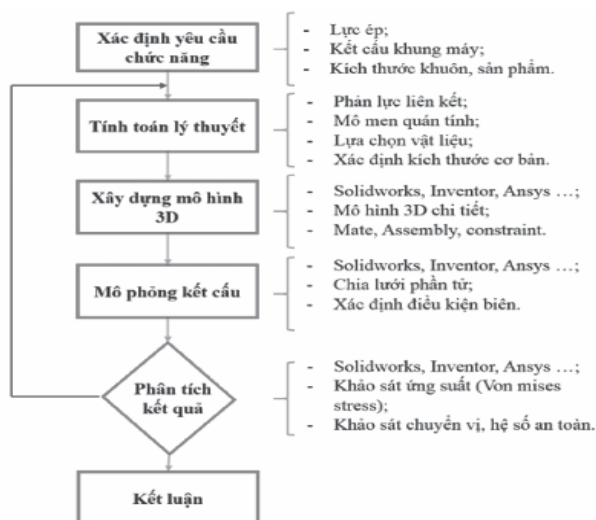
Hình 1. Lưu trình toán thiết kế, tối ưu khung máy ép thủy lực
