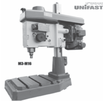
Hình 1. Máy taro tự động Unifast T-6516 M16 [2].
